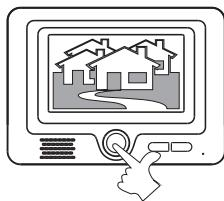
В режиме ожидание на любом мониторе: одно нажатие "Monitor" позволяет наблюдать внешнюю ситуацию с вызывной панели №1, двойное нажатие - панели №2, третье - выключит монитор.
