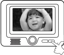
Нажмите "Unlock" на любом мониторе для открытия замка.
