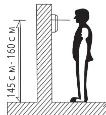
Оптимальная высота установки монитора 145 - 160 см.
