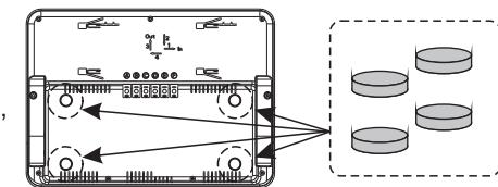
1. Установите подкладки на задней части монитора, как показано на рисунке
